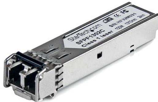
El modelo SFPF1302C es un módulo transceptor por fibra óptica, compatible con el modelo GLC-FE-100FX de Cisco, diseñado, programado y probado para su funcionamiento con enrutadores y conmutadores de la marca Cisco®. Ofrece conectividad confiable a 100Mb a través de cableado de fibra, para redes compatibles con 100BASE-FX, a una distancia máxima de hasta 2km.
