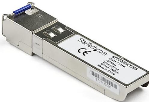
Il SFPFE20KT3R5 è un ricetrasmettitore SFP a monte in fibra compatibile con Juniper SFP-FE20KT13R15 associabile con SFPFE20KT5R3 di StarTech.com. Sono progettati, programmati e testati per funzionare con switch e router compatibili MSA 100BASE-BX10-U. Il modulo ricetrasmettitore SFP+ supporta una distanza massima di fino a 20 km e offre una connettività affidabile 100 MbE usando cavi in fibra.
