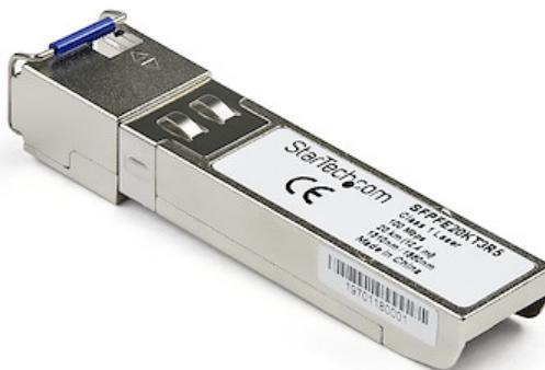
Il SFPFE20KT5R3 è un ricetrasmettitore SFP a valle in fibra compatibile con Juniper SFP-FE20KT15R13 associabile con SFPFE20KT3R5 di StarTech.com. Sono progettati, programmati e testati per funzionare con switch e router compatibili MSA 100BASE-BX10-D. Il modulo ricetrasmettitore SFP+ supporta una distanza massima di fino a 20 km e offre una connettività affidabile 100 MbE usando cavi in fibra.
