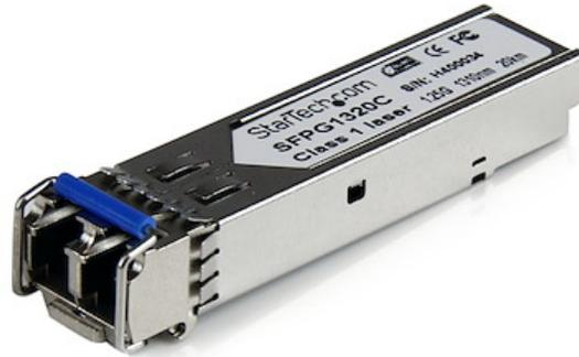
Le modèle SFPG1320C est un module de transceiver à fibre optique compatible avec Cisco GLC-LH-SMD, qui a été conçu, programmé et testé pour fonctionner avec les commutateurs et routeurs de la marque Cisco®. Il fournit une connectivité 1 GbE fiable sur câble à fibre optique pour les réseaux conformes aux spécifications 1000BASE-LH, avec une distance maximale de 20 km.
