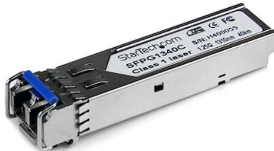
El módulo SFP para transceptor SFPG1340C de fibra óptica Cisco® Compatible Gigabit SM LC, 40 km, está fabricado para ajustarse a las normas MSA ("Multi-Sourcing Agreement", acuerdo multifuente) y es una alternativa económica para agregar, reemplazar o actualizar un puerto LC de modo único en un equipo de red Gigabit de fibra óptica o un conversor de medios de fibra óptica.
