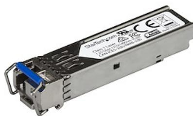
Le SFPGE10KT4R3 est un module de transceiver SFP fibre optique compatible Juniper SFP-GE10KT14R13 qui a été conçu, programmé et testé pour fonctionner avec des commutateurs et des routeurs de marque Juniper®. Il vous assure une connectivité de 1 GbE par câble en fibre optique, sur les réseaux compatibles 1000BASE-BX10-D et sur une distance maximale de 10 km.
