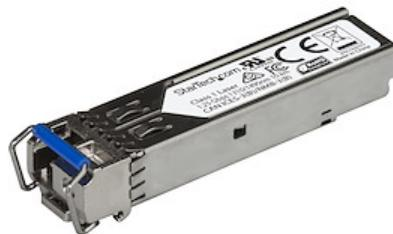
Il SFPGE10KT4R3 è un modulo ricetrasmettitore SFP in fibra compatibile con Juniper SFP-GE10KT14R13 progettato, programmato e testato per funzionare con switch e router prodotti da Juniper®. Offre una connettività affidabile 1 GbE su cavo in fibra per le reti compatibili con 1000BASE-BX10-D a una distanza massima di 10 km.
