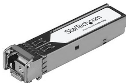
Il SFPGE10KT5R3 è un modulo ricetrasmettitore SFP in fibra compatibile con Juniper SFP-GE10KT15R13 progettato, programmato e testato per funzionare con switch e router prodotti da Juniper®. Offre una connettività affidabile 1 GbE su cavo in fibra per le reti compatibili con 1000BASE-BX10-D a una distanza massima di 10 km.
