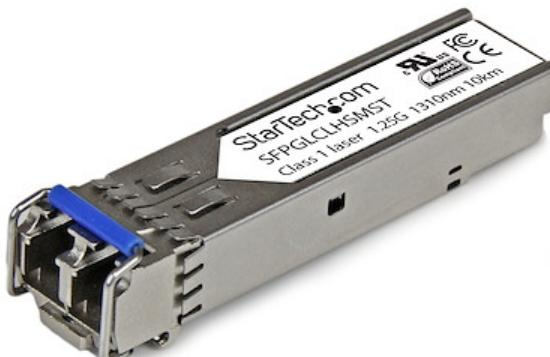
Das SFPGLCLHSMST ist ein Cisco GLC-LH-SM-kompatibles Glasfaser-Transceiver-Modul, das speziell für die Zusammenarbeit mit Cisco®-Switches und -Router entwickelt, programmiert und getestet wurde. Es liefert zuverlässige 1-GbE-Konnektivität (1000 Mbit/s) über Glasfaserkabel für 1000BASE-LX/LH-konforme Netzwerke mit einer maximalen Entfernung von bis zu 10 km.
