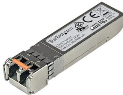
Il SFPP10GELRMS è un modulo ricetrasmittitore SFP+ in fibra compatibile con Juniper SFPP-10GE-LRM progettato, programmato e testato per funzionare con switch e router prodotti da Juniper®. Offre una connettività affidabile 10 GbE su cavo in fibra per le reti compatibili con 10GBASE-LRM a una distanza massima di 2 km.
