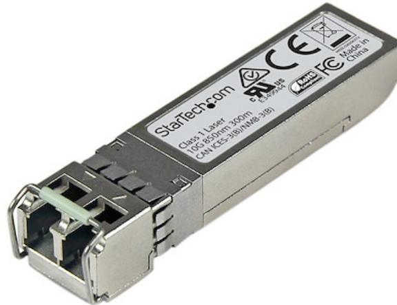
Der SFPP10GESRST ist ein Juniper SFPP-10GE-SR-kompatibles Glasfaser SFP+-Transceiver-Modul, das für den Einsatz mit Juniper® Marken-Switches und -Routern entwickelt, programmiert und getestet wurde. Es sorgt für zuverlässige 10 GbE-Konnektivität über Glasfaser-Kabel für 10GBASE-SR-konforme Netzwerke mit einer maximalen Entfernung von bis zu 300m.
