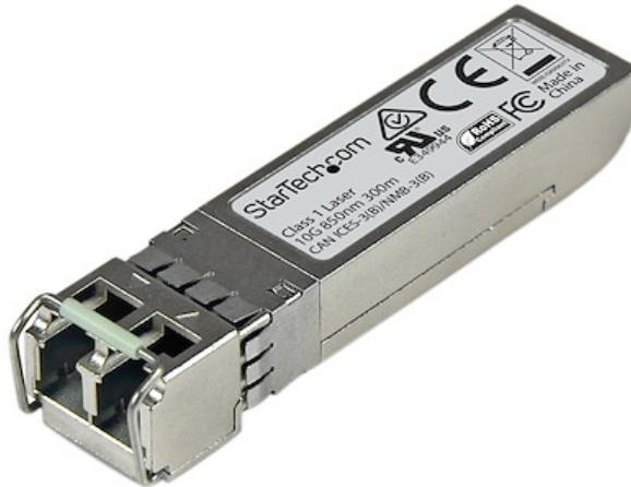
Il SFPP10GESRST è un modulo ricetrasmettitore SFP+ in fibra compatibile con Juniper SFPP-10GE-SR progettato, programmato e testato per funzionare con switch e router prodotti da Juniper®. Offre una connettività affidabile 10 GbE su cavo in fibra per le reti compatibili con 10GBASE-SR a una distanza massima di 300 m.
