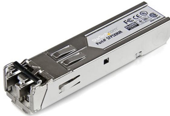
El modelo SFPSXMM es un transceptor SFP por fibra óptica, conforme a las normas MSA y TAA, diseñado, programado y probado para su funcionamiento con enrutadores y conmutadores 1000BASE-SX compatibles con MSA. El módulo transceptor SFP admite una distancia máxima de hasta 550m y conectividad fiable a 10GbE a través de cableado de fibra. <b>Especificaciones técnicas:</b>
