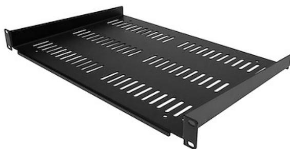
SHELF-1U-12-FIXED-V le permite añadir un estante de 1U de 12 pulgadas (30,5cm) de profundidad a cualquier rack o armario de 19 pulgadas que cumpla con la normativa EIA-310. El estante está ventilado para mejorar el flujo de aire y ayudar a reducir las temperaturas en su rack.
