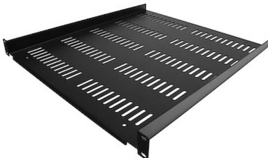
Le SHELF-1U-20-FIXED-V vous permet d'ajouter une étagère de 1U 50,8 cm (20 pouces) de profondeur à tout rack ou armoire 19 pouces conforme à la norme EIA-310. L'étagère est ventilée pour améliorer la circulation de l'air et aider à abaisser les températures dans votre rack.
