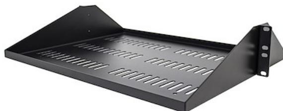
SHELF-2U-14-CENTER-V le permite añadir un estante de 2U de 14 pulgadas (35,6cm) de profundidad a cualquier rack de 19 pulgadas de 2 postes que cumpla la norma EIA-310. El estante está ventilado para mejorar el flujo de aire y ayudar a reducir las temperaturas en su rack.
