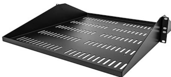
Le SHELF-2U-20-CENTER-V vous permet d'ajouter une étagère de 2U 50,8 cm (20 pouces) de profondeur à n'importe quel rack ou armoire 19 pouces à 2 montants conforme à la norme EIA-310. L'étagère est ventilée pour améliorer le flux d'air et aider à abaisser les températures dans votre rack.
