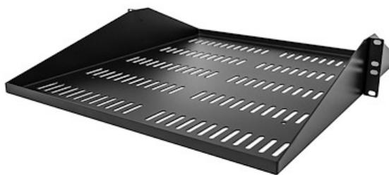
Lo SHELF-2U-20-CENTER-V permette di aggiungere un ripiano da 2U da 50,8 cm di profondità a qualsiasi server rack a 2 montanti da 19 pollici conforme a EIA-310. Il ripiano è ventilato per migliorare il flusso d'aria e aiutare a ridurre le temperature nell' armadio rack.
