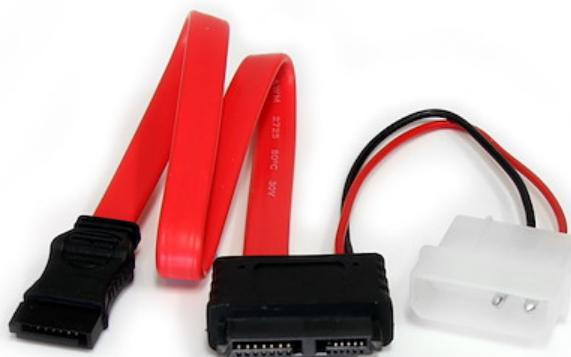
El cable Slimline SATA a SATA con alimentación LP4 SLSATAF12 de 30 cm incluye una receptáculo de datos SATA y una conexión de alimentación LP4 en un extremo y una toma serial ATA Slimline en el otro extremo, lo cual permite conectar una unidad SATA Slim a una placa madre que no tiene conexión Slimline disponible.
