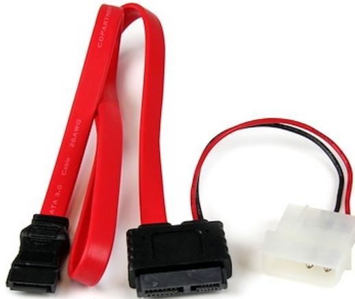
El cable Slimline SATA a SATA con alimentación LP4 SLSATAF36 de 91 cm incluye un receptáculo de datos SATA y una conexión de alimentación LP4 en un extremo y una toma serial ATA Slimline en el otro extremo, lo cual permite conectar una unidad SATA Slim a una placa madre que no tiene conexión Slimline disponible.
