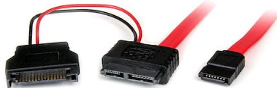
El Adaptador de Línea Delgada de 50 cm, SLSATAF50CMS ofrece una conexión de datos SATA hembra (7 pines) y una conexión de alimentación SATA en un extremo, y una conexión Serial ATA hembra de línea delgada (slimline) en el otro, permitiendo conectar un disco óptico de línea delgada a un controlador y a una conexión de alimentación SATA.
