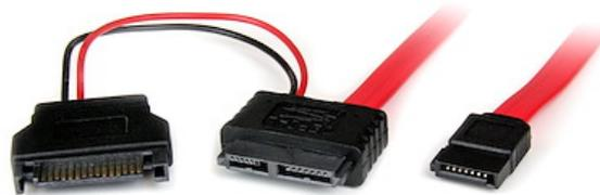
L'adaptateur Slimline SLSATAF50CMS de 50 cm est doté d'un connecteur de données femelle SATA (7 broches) et d'un connecteur d'alimentation SATA à une extrémité avec un connecteur Serial ATA Slimline femelle à l'autre extrémité, ce qui vous permet de brancher un lecteur optique Slimline à un contrôleur et à une alimentation SATA.
