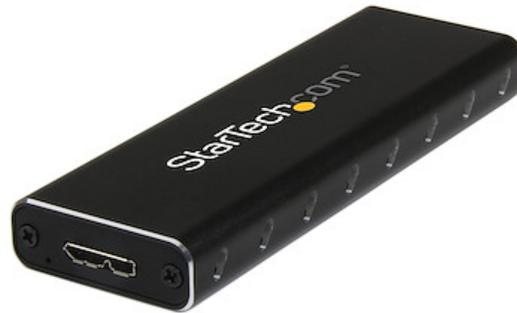
USB 3.0 - M.2(NGFF) 外付けケース。SATA M.2ソリッドステート ドライブをポータブルな高速USB 3.0ドライブとして使用します。
