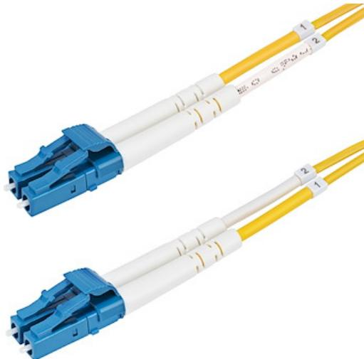
Le câble de raccordement en fibre optique duplex monomode LC à LC OS2 facilite la connectivité à travers les réseaux 100G. Il prend en charge le Multiplexage par Répartition de Longueurs d'Onde (CWDM) sur une plage de longueurs d'onde étendue de 1260 à 1625 nm, améliorant l'isolation des canaux pour une force de signal optimale sur de longues distances.
