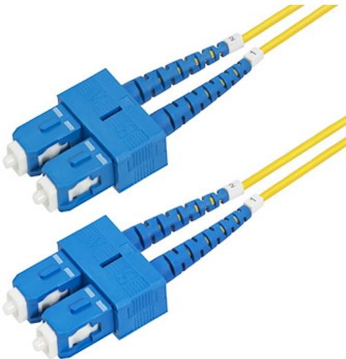
Il cavo patch in fibra ottica OS2 SC a SC Single Mode Duplex facilita la connettività nelle reti 40G/100G. Supporta il Coarse Wavelength Division Multiplexing (CWDM) su una gamma estesa di lunghezze d'onda di 1260-1625 nm, migliorando l'isolamento dei canali per una forza del segnale ottimale su lunghe distanze.
