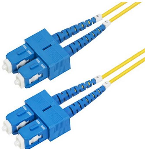
Le câble de raccordement en fibre optique duplex monomode SC à SC OS2 facilite la connectivité à travers les réseaux 40G/100G. Il prend en charge le Multiplexage par Répartition de Longueurs d'Onde (CWDM) sur une plage de longueurs d'onde étendue de 1260 à 1625 nm, améliorant l'isolation des canaux pour une force de signal optimale sur de longues distances.
