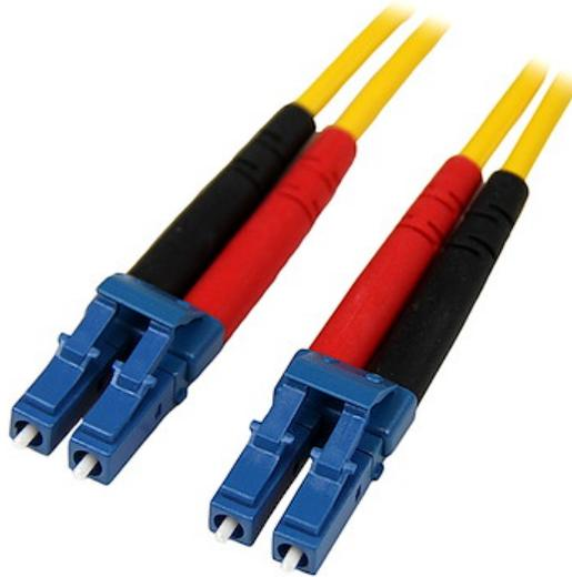
Il cavo in fibra duplex a modalità singola LC a LC 1 m SMFIBLCLC1 presenta una fibra da 9/125 micron per trasmissioni dati ad alta velocità ed elevata larghezza di banda tramite reti Gigabit Ethernet e Fiber Channel con il supporto di applicazioni in modalità singola.
