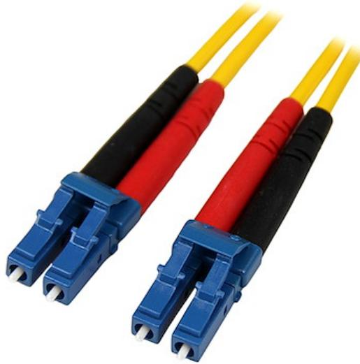
Le câble à fibre optique duplex monomode LC vers LC SMFIBLCLC7 de 7 m comprend une fibre de 9/125 microns pour la transmission de données haute vitesse, à large bande passante sur des réseaux Gigabit Ethernet et Fiber Channel, avec la prise en charge d'applications duplex monomode.
