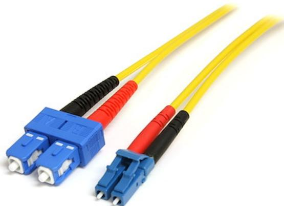
El cable de fibra óptica (1 m), LC a SC, dúplex de modo único, modelo SMFIBLCSC1, con fibra óptica de 9/125 micrones, permite transmisiones de datos a alta velocidad y alto ancho de banda, a través de redes Gigabit Ethernet y canal de fibra, con soporte para aplicaciones dúplex de modo único.
