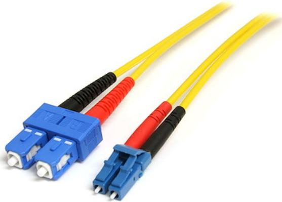
Le câble à fibre optique duplex monomode LC vers SC SMFIBLCSC4 de 4 m comprend une fibre de 9/125 microns pour la transmission de données haute vitesse, à large bande passante sur des réseaux Gigabit Ethernet et Fiber Channel, avec la prise en charge d'applications duplex monomode.
