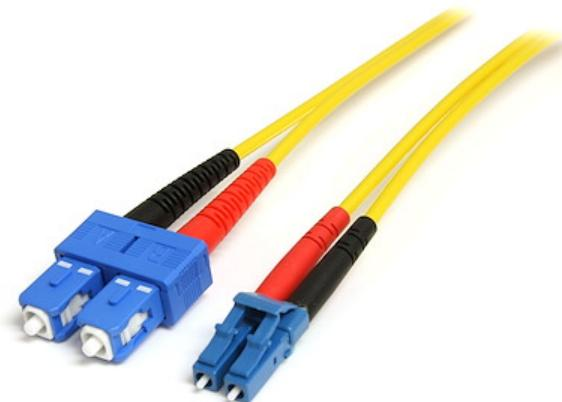
Il cavo in fibra duplex a modalità singola LC a SC 7 m SMFIBLCSC7 presenta una fibra da 9/125 micron per trasmissioni dati ad alta velocità ed elevata larghezza di banda tramite reti Gigabit Ethernet e Fiber Channel con il supporto di applicazioni in modalità singola.
