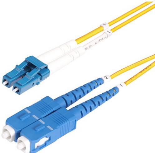
Le câble de raccordement à fibre optique duplex monomode OS2 LC vers SC facilite la connectivité sur les réseaux 100G. Il prend en charge la multiplexage par répartition en longueur d'onde (CWDM) sur une plage de longueurs d'onde étendue de 1260 à 1625 nm, améliorant l'isolation des canaux pour une force de signal optimale sur de longues distances.
