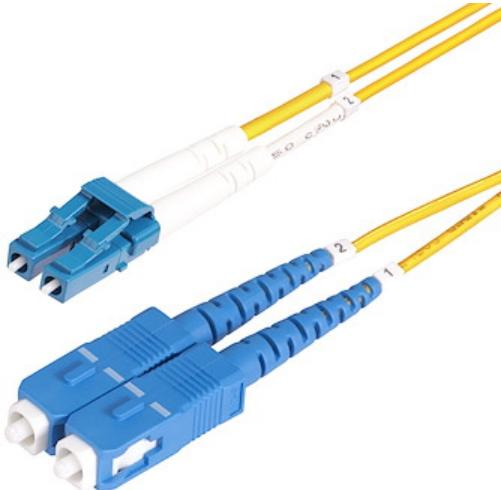
Le câble patch fibre optique duplex monomode OS2 LC vers SC facilite la connectivité sur les réseaux 100G. Il prend en charge la multiplexage par répartition en longueur d'onde (CWDM) sur une plage étendue de longueurs d'onde de 1260 à 1625 nm, améliorant l'isolation des canaux pour une force de signal optimale sur de longues distances.
