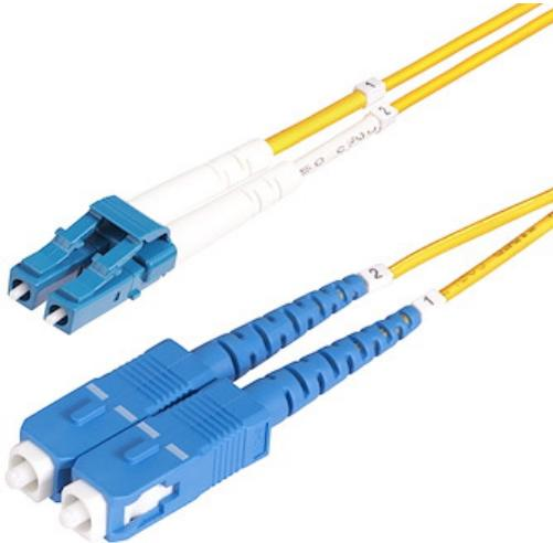
Le câble patch fibre optique duplex monomode OS2 LC vers SC facilite la connectivité sur les réseaux 100G. Il prend en charge le multiplexage par répartition en longueur d'onde (CWDM) sur une plage étendue de longueurs d'onde de 1260 à 1625 nm, améliorant l'isolation des canaux pour une force de signal optimale sur de longues distances.
