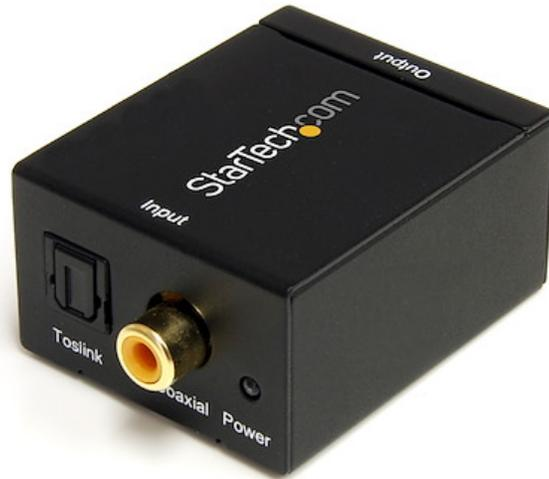
El Conversor de Audio Toslink/Óptico SPDIF a RCA Estéreo, SPDIF2AA permite convertir una señal de entrada Digital Coaxial o Toslink/Óptico de 2 canales en una salida estéreo analógica RCA.
