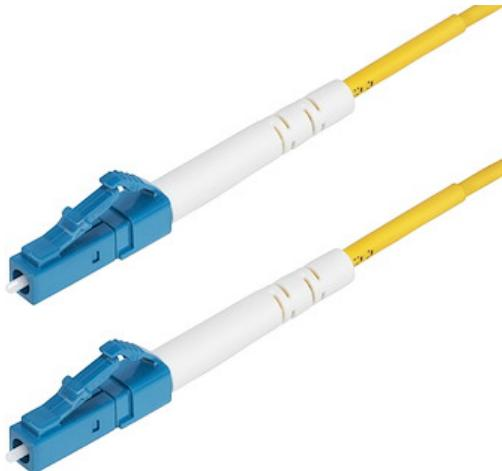
Le câble de raccordement à fibre optique monomode LC à LC OS2 facilite la connectivité sur les réseaux 40G/100G. Il prend en charge la multiplexage par répartition en longueur d'onde (CWDM) sur une plage de longueurs d'onde étendue de 1260 à 1625 nm, améliorant l'isolation des canaux pour une force de signal optimale sur de longues distances.
