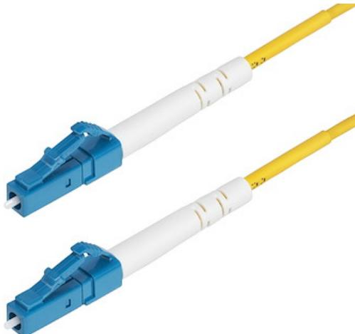
Le câble de raccordement en fibre optique monomode simplex LC à LC OS2 facilite la connectivité à travers les réseaux 40G/100G. Il prend en charge le Multiplexage par Répartition de Longueurs d'Onde (CWDM) sur une plage de longueurs d'onde étendue de 1260 à 1625 nm, améliorant l'isolation des canaux pour une force de signal optimale sur de longues distances.
