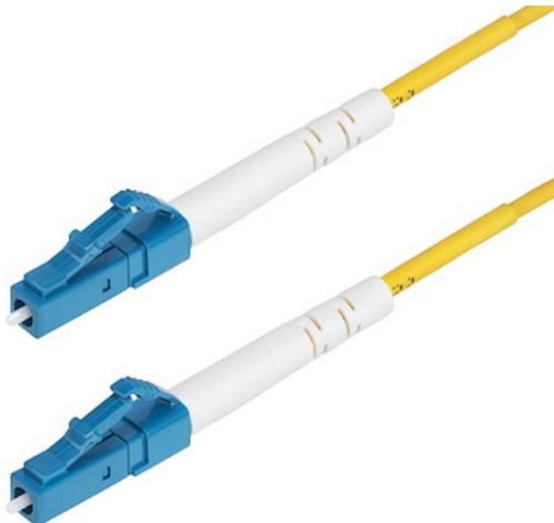
El cable de parcheo de fibra óptica simplex LC a LC OS2 monomodo facilita la conectividad en redes 40G/100G. Es compatible con la multiplexación por división de longitud de onda gruesa (CWDM) en una amplia gama de longitudes de onda de 1260-1625 nm, lo que mejora el aislamiento de los canales para obtener una intensidad de señal óptima en largas distancias.
