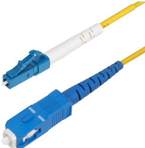
El cable de parcheo de fibra óptica simplex LC a SC OS2 monomodo facilita la conectividad en redes 40G/100G. Es compatible con la multiplexación por división de longitud de onda gruesa (CWDM) en una amplia gama de longitudes de onda de 1260-1625 nm, lo que mejora el aislamiento de los canales para obtener una intensidad de señal óptima en largas distancias.
