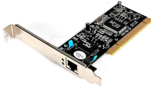
Cette carte adaptateur réseau Ethernet Gigabit basée sur PCI 10/100/1000 Mbps offre une connexion simple au réseau Ethernet Gigabit et est entièrement compatible avec les normes IEEE 802.3, 802.3u, 802.3ab et 802.3x.
