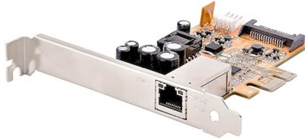
La tarjeta de red Power over Ethernet PCIe permite velocidades multigigabit de 2,5/1Gbps y 100/10Mbps. Este adaptador LAN PoE puede proporcionar hasta 25,5 W de potencia a un dispositivo conectado. Combina una conexión de datos de red y alimentación a través de un solo cable Ethernet Cat5e (o mejor). Esta NIC PoE es la solución ideal para proporcionar tanto alimentación como comunicación de red a una instalación remota.
