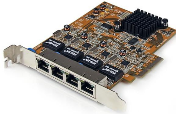
La carte Ethernet 4 ports ST1000SPEX42 est un adaptateur réseau PCI-E conforme aux normes IEEE 802.3/u/ab, qui ajoute des connexions sur jusqu'à quatre réseaux Gigabit haute vitesse distincts à partir d'un client, d'un serveur ou d'un poste de travail unique.
