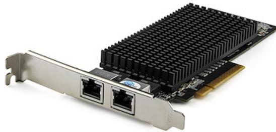
Esta tarjeta de red PCIe 10Gb de doble puerto le ofrece una forma versátil y económica de implementar conectividad 10GbE de red. Le permite agregar dos puertos Ethernet de cobre a su servidor u ordenador de sobremesa y permitir el acceso Multi-Ethernet Gigabit a su red a cinco velocidades: 10G, 5G, 2,5G, 1G y 100Mbps.
