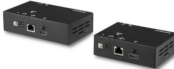
カテゴリ6ケーブル使用HDMIエクステンダ。HDMIオーディオ／ビデオ信号を最大100m離れたリモートロケーションに延長します。
