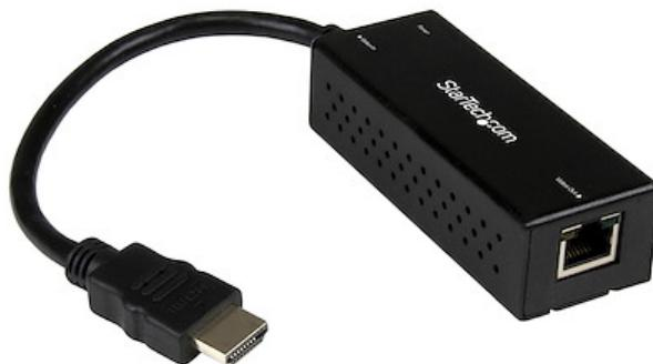
Ce transmetteur compact utilise la technologie HDBaseT™ pour étendre votre signal HDMI® jusqu'à 70 mètres avec un câble simple CAT5e ou CAT6, vers un écran, vidéoprojecteur ou récepteur HDBaseT (vendu séparément). Le transmetteur prend en charge les résolutions vidéo Ultra HD et Full HD (4K et 1080p), avec une prise en charge de l'audio numérique 7.1 qui les accompagne.
