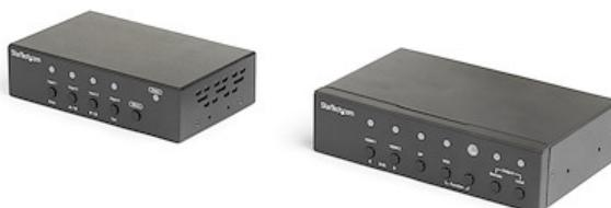
Questo kit extender HDBaseT™ multi-ingresso consente di estendere i segnali A/V a una posizione remota fino a una distanza di 70 m. È dotato di uno switch e di uno scaler integrati che permettono di scegliere l'uscita tra quattro sorgenti video indipendenti (2 HDMI, 1 VGA e 1 DisplayPort).
