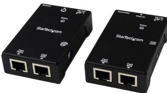
Le kit d'extendeur vidéo HDMI® sur câble Cat5e/Cat6 ST121SHD50 vous permet d'étendre les signaux vidéo et audio HDMI jusqu'à 50 m avec deux câbles Cat5e ou Cat6. Pour une polyvalence accrue, le kit comprend Power over Cable et ne nécessite qu'un seul adaptateur d'alimentation que vous pouvez connecter au transmetteur ou au récepteur.
