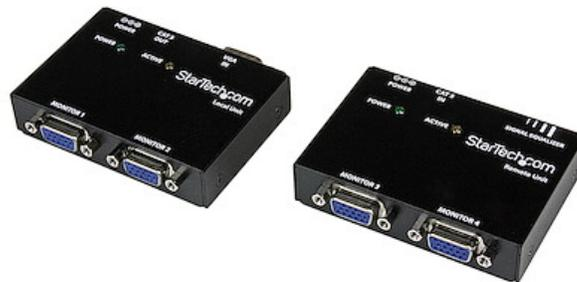
L'extendeur vidéo VGA sur Cat 5, référence ST121UTPEU, vous permet d'étendre votre signal vidéo VGA à au plus 150 mètres et de connecter jusqu'à 4 écrans (2 localement et 2 à distance), à partir de cette source unique. Le ST121UTPEU est un kit complet incluant une unité locale de transmission et une unité réceptrice, offrant ainsi une solution complète dans les cas où des écrans distants sont requis.
