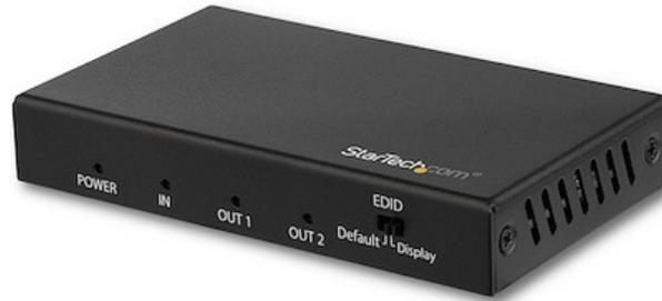
Este divisor de 2 puertos HDMI 4K conecta su fuente de video HDMI simultáneamente a dos pantallas HDMI, sin distorsión ni degradación de su señal de video. Para un rendimiento confiable, el bifurcador viene dentro de un duradero gabinete de metal que permite el enfriamiento pasivo.
