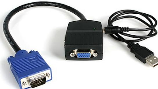
Mit diesem 2-Port VGA-Videosplitter können Sie VGA-Anzeige eines Computers auf zwei Monitoren gleichzeitig ausgeben.
